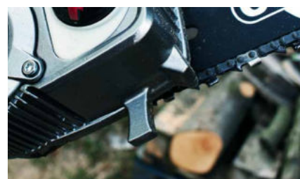
Haken zum Herausziehen von Ästen aus dem Baum ohne Arbeitsunterbrechung.
